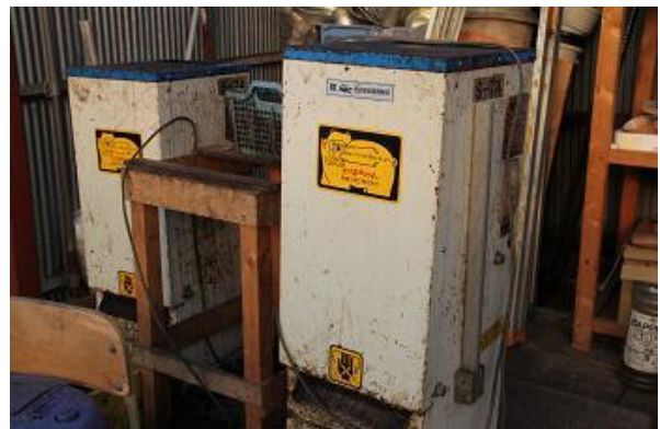
空き缶潰し機「カバちゃん」: 電動の自動潰し機。
